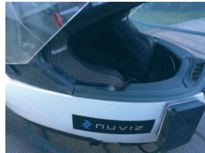
▲ Nuviz Hud voidaan helposti irrottaa kypärästä ja laittaa kontaktinastojen päälle suojakansi.
