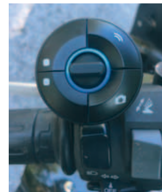
▲ Tällä Controllerilla ohjataan kypärään kiinnitettyä Hudia.
