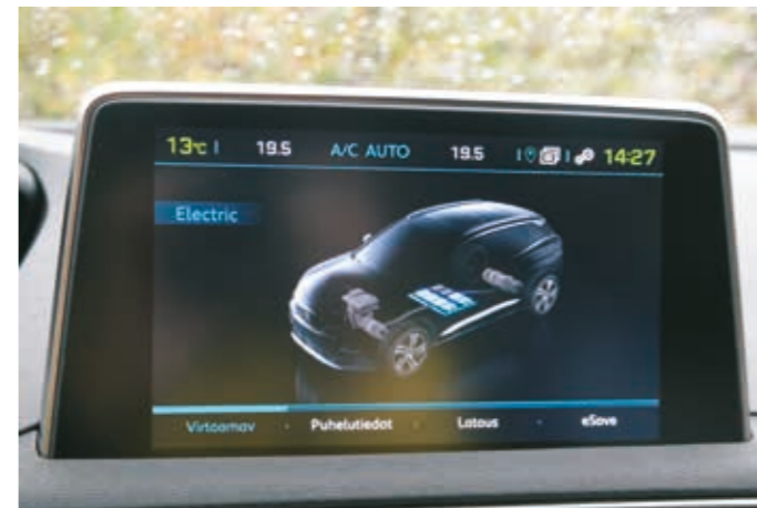
▲ Multimedianaäytöltä voi seurata, miten voimavirrat liikkuvat moottoreiden ja akkujen välillä. Saman näkymän saa myös mittariston keskelle.
