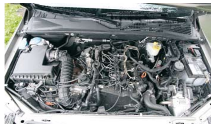
▲ Konehuoneessa jyllää 160 hevosvoimaa kehittävä 2,0-litrainen kaksoisahdettu dieselmoottori.
