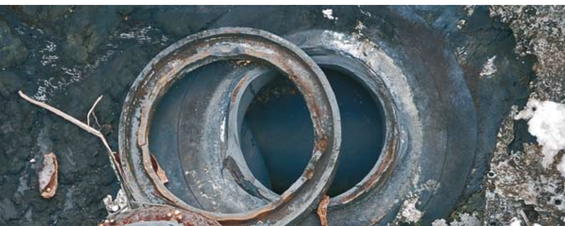
◀ Lockheed P-38 Lightningin polttoainetankki on ympäröity paksulla kumivai-palla.
