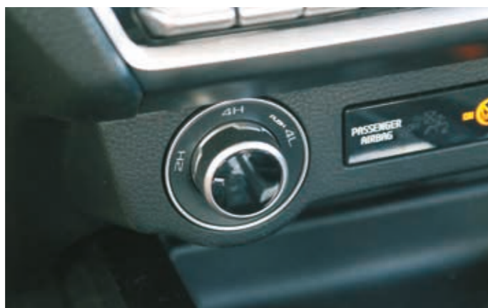
▲▼ Nelivetovalitsin on kojelaudassa ja keskikonsolista löytyvät takatasauspyörästön lukon ja alamäkihidadstimen katkaisimet.
