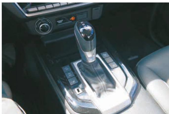
▲▼ Nelivetovalitsin on kojelaudassa ja keskikonsolista löytyvät takatasauspyörästön lukon ja alamäkihidadstimen katkaisimet.
