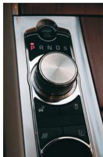
▲ Nopeatoimisen 8-vaihteisen automaattivaihteiston ohjaus hoidetaan Drive Selector -kierovalitsimella.
