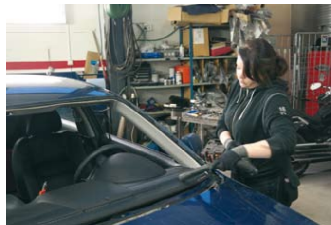
Reeta Aalto imuroi saumakohtat puhtaaksi ja leikkaa vanhan liimapalon tasaiseksi.
