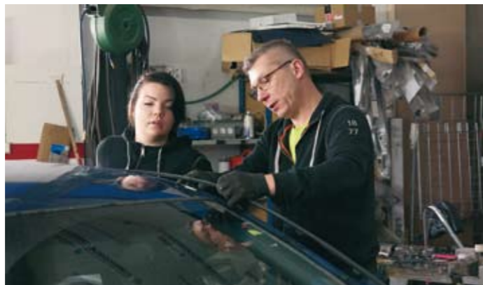
Liimanauhan alle ujutettavalla langalla leikataan liimapalko, jolloin saadaan tuulilasi irrotettua.
