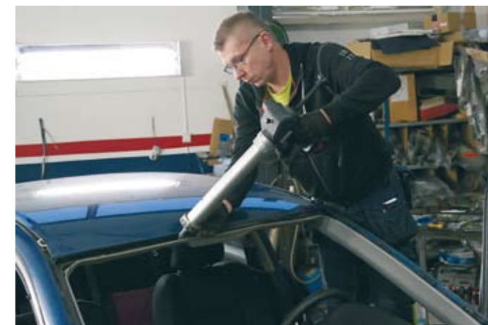
Markku Aalto levittää uuden liiman korilaippaan.
