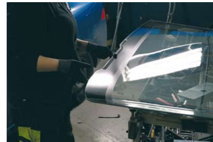
Uuden tuulilasin reunat käsitellään ennen uutta liimaa.
