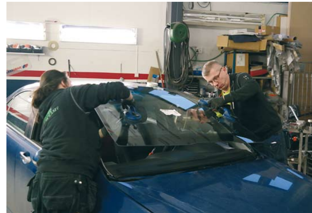
Reeta Aalto imuroi saumakohtat puhtaaksi ja leikkaa vanhan liimapalon tasaiseksi.
