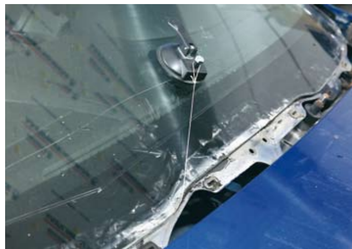
Liimanauhan alle ujutettavalla langalla leikataan liimapalko, jolloin saadaan tuulilasi irrotettua.
