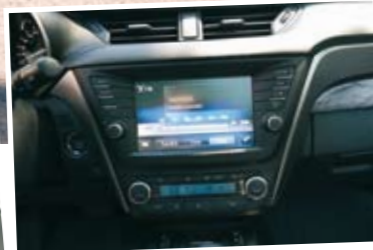
▲ Kojelaudan keskustaa hallitsee isolla 8-tuumaisella kosketusnäytöllä varustettu suomenkielinen Toyota Touch -mediakeskus, jonka ominaisuuksiin kuuluvat normaalien audio-toimintojen lisäksi Bluetooth, USB-liitäntä sekä peruutuskamera.
