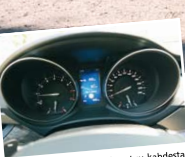
▲ Avensiksen mittaristo koostuu kahdesta voimakkaasti upotetusta elementistä ja niiden väliin sijoitetusta TFT-värinäytöstä.
