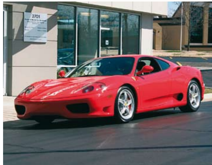
▲ ▼ Eräs parhaiten mieleen jääneistä autoista, mitä miehet ovat vuosien mittaan tuoneet on ollut kuvan Ferrari 360 Modena F1. 3,6 litran V8 ja 400 hv. Huippuja lähes 300 km/h ja 0-100 km/h 4,5 sekuntia...
