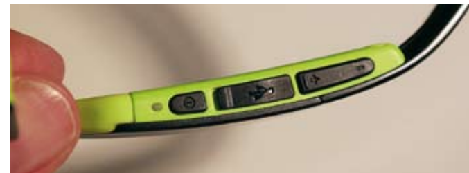
▲ Virtapainikkeen (vas.) vieressä ensimmäisenä mikro-USB-latausliitäntä ja äärimmäisenä äänenvoimakkuussäädin.
