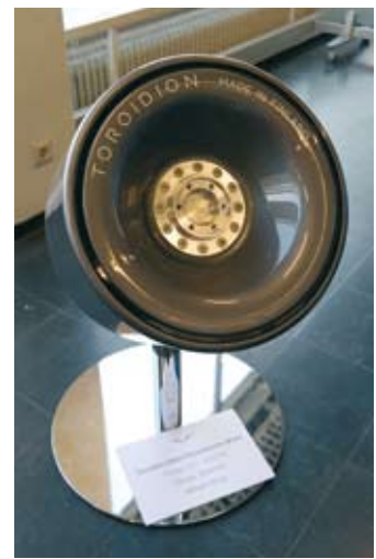
▼ Tässä on Toroidionin mullistava sähkömoottori, jollainen on jokaiseen pyörään. Vääntöä hulppeat 7500 Nm ja voimaa 300-600 kW eli kun näitä on autossa neljä kappaletta, voimaa riittää vaikka toisille jakaa...
