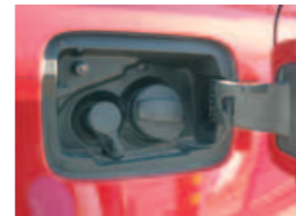
Ulkoisesti TGI-version erottaa polttomoottoriveljestään vain takana olevasta kaasun täyttösuulakkeesta (vas.).
