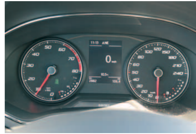
Mittaristossa on oma mittari kaasulle (vas.) ja bensiinille (oik.).
