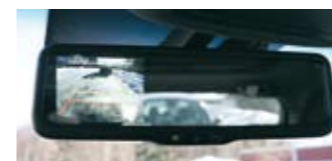
▲ Peruuskameran näyttö on peruutuspeilissä – kätevää!
