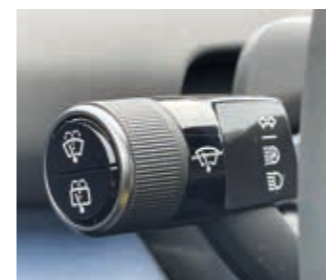
▲ Vasemmanpuoleiseen viikseen on yhdistetty viikkujen lisäksi lasinpyyhkijöiden käyttörulla ja viiksen päähän pesurit.
