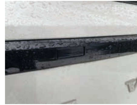
▲ Takaluukun aukaisu ei onnistu jalkaa puskurin alla heilutteleamalla eikä avaimesta, vaan pienestä nappulasta takaluukun koristelistan keskellä.
