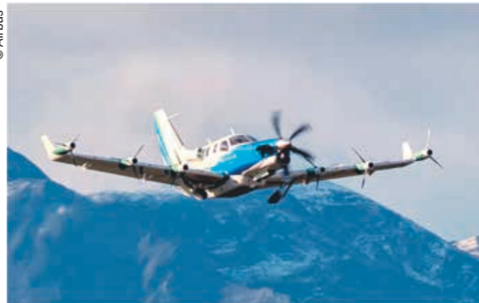
▲ Airbusin Ecopulse liitelee yhden polttomoottorin ja kuuden sähkömoottorin avulla.
