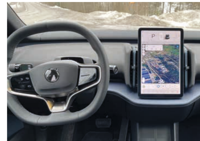
▲ Vasemmanpuoleiseen viikseen on yhdistetty viikkujen lisäksi lasinpyyhkijöiden käyttörulla ja viiksen päähän pesurit.
