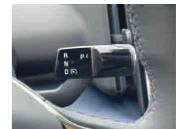
▲ Oikeanpuoleinen viiksi toimii vaihte-keppinä eli suunnanvaihtimena.
