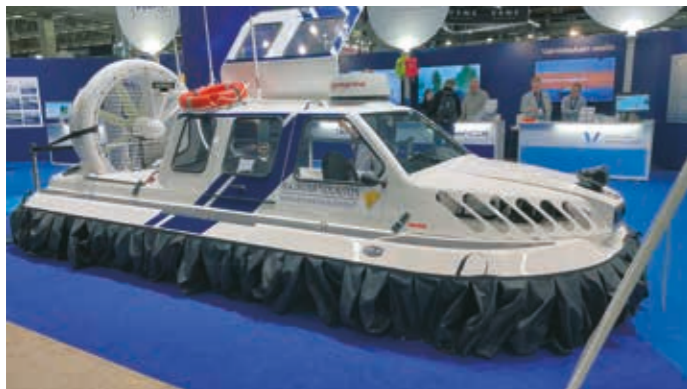
▼ Rajavartioston osastolla oli esillä ruotsalaisvalmisteinen 5 hengenilmatyynyalus IA 09, työntömoottori 120 hv, nostomoottori 29 hv, leijuntakorkeus 0,30 cm.
