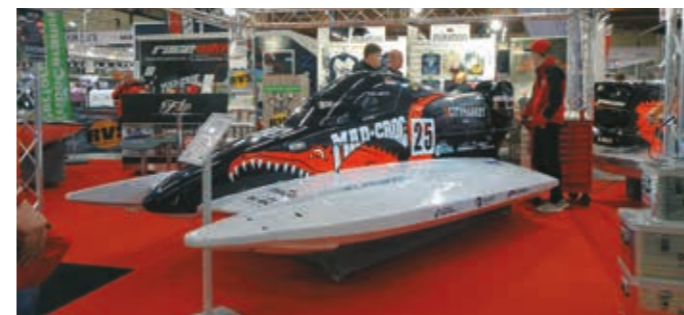
▼ Tino Lehdon ohjastama Formula 4-luokan kilpavene. Mercuryn 60 hv nelitahtinen perämoottori kuljettaa venettä maksimissaan 120 km/h.
