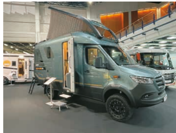
▲ Hymer Venture S on Mercedes-Benz Sprinter 419 CDI alustalle rakennettu puoli-integroitu matkailuauto, joka on varustettu jatkuvalla nelivedolla – eli ei jää kiinni ihan pienimpään kannokkoon. Ylös nouseva katto avartaa makuutiloja. Hintaa löytyy 257.975 euroa.
