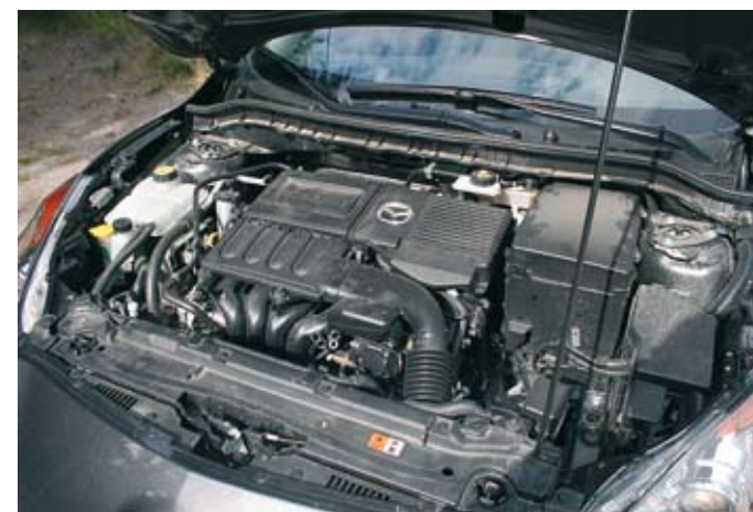
▲ Mazda3:n nelisylinterisessä rivimoottorissa on kaksi yläpuolista nokka-akselia ja jaksoitettu venttiilien ajoitusjärjestelmä.
