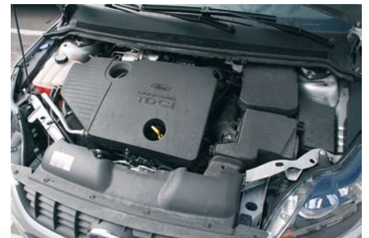
▲ Ford Focusin Duratorq TDCi -dieselmallista irtoaa 115 hevosvoimaa ja vääntöäkin mukavat 280 Nm.
