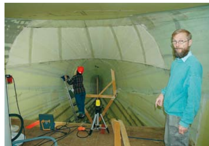
▲ Aluksen rungon muodostaa lasikuitu – finnfoam – lasikuitu kerrosrakenne. – Lämpöeriste muodostaa samalla veneen rungon. Eriste on paksu koska vene valmistuu ympärivuotiseen käyttöön. Tarvittava lämpöenergian määrä on erittäin pieni tietää Jorma Ponkala.
