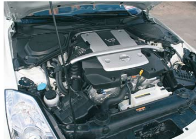
▲ Pitkittäin eteen keskelle asennetussa 3.5 -litraisessa, kuusisylinterisessä V-mootorissa on juhlavasti 313 hevosvoimaa – kyllä lähtee...
