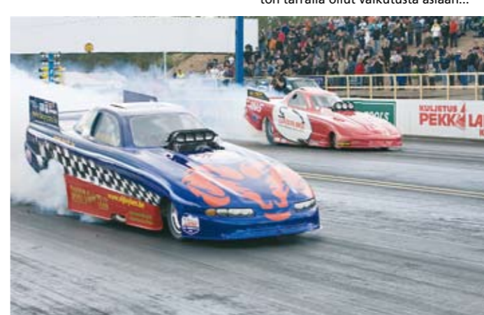
▲ Funny Car -autossa käytetään hiilikuitukoria, joka muistuttaa ulkonäöltään varsin paljon normaaliautoa.
