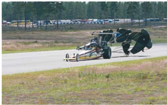
▼ Neljännesmailin jälkeen jarruvarjot aukeavat ja hidastavat nitro-ohjuksen menoa suoran päässä.
