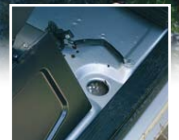
▲ Ohjaimon lattiasa on pohjajatulppa, josta voi sisään tulleen veden laskea pois kuivalle maalle päästyä.
