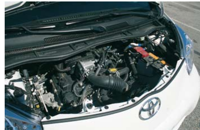
▲ Niin iQ:n kuin Altonkin konepellin alla murisee 68 hevosvoimaa. iQ:n moottori on tuttu jo Toyota Aygon keulalta, Altoa taas on saatavissa Suzuki Splashissakin käytöllä moottorilla.
