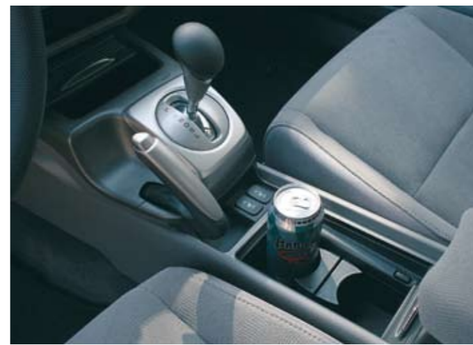
▲ Civic Hybridissä on käytössä portaaton CVT-vaihteisto.
