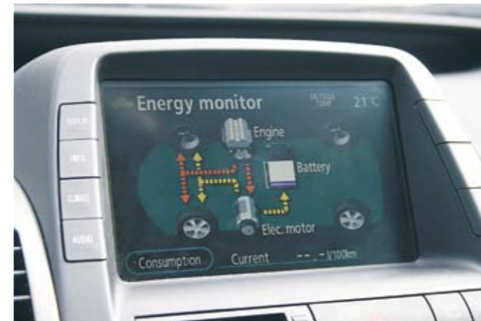
▲ Priuksessa voi seurata moottorien toimintaa ja energian käyttöä erittäin havainnollisesta näytöstä.
