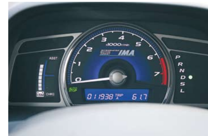
▲ Civicissä voi akkujen latausastetta seurata nopeusmittarin vasemmassa puolella olevasta pylvästä.
