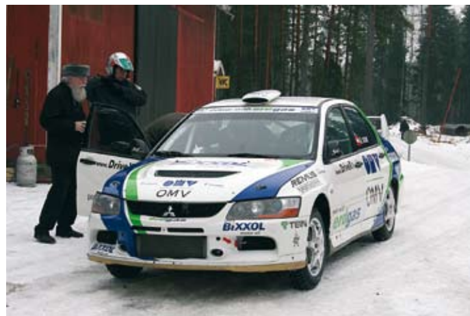
▲ Tavallisesta N-ryhmän Mitsubishi Lancer Evolution 9-ralliautosta muutettu kaasuauto ei ulospäin näytä eikä kuulosta mitenkään poikkeavalta. Näkyvimmat erot ovat tavaratilassa sijaitseva yksi suuri kaasutankki ja toinen takaistuimen paikalla. Niihin voi tankata sekä maa- että biokaasua.
